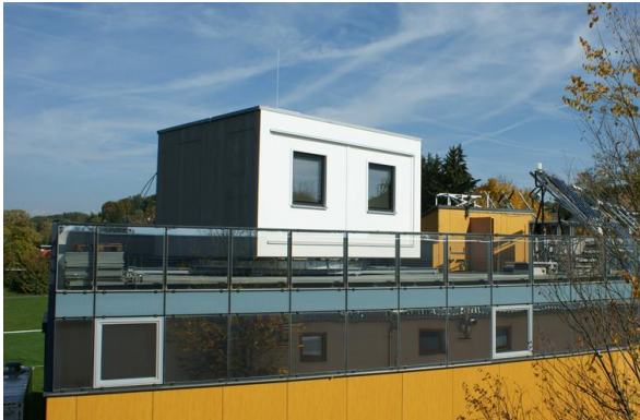
Abbildung 1 zeigt die Test- und Prüfboxen für Fassaden und Fassadenelemente der Zukunft angeordnet am Dach des Prüflabors von AEE INTEC (Bildquelle AEE INTEC)
