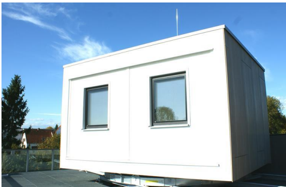
Abbildung 2 zeigt die Außenansicht der beiden drehbaren Test- und Prüfboxen für Fassaden und Fassadenelemente der Zukunft inkl. dem Einbau von 2 Prüflingen (Fenster). (Bildquelle AEE INTEC)
