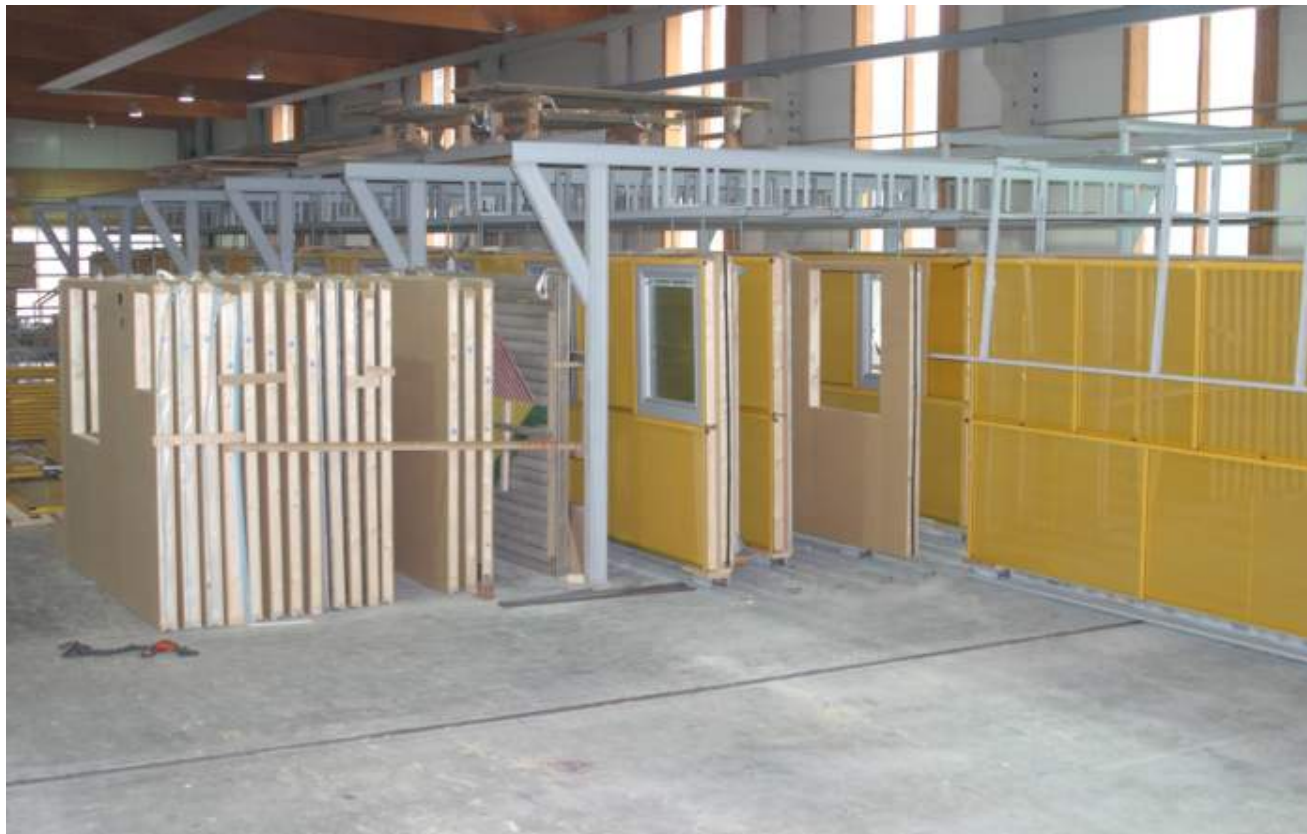
Lagerung der Wandelemente
