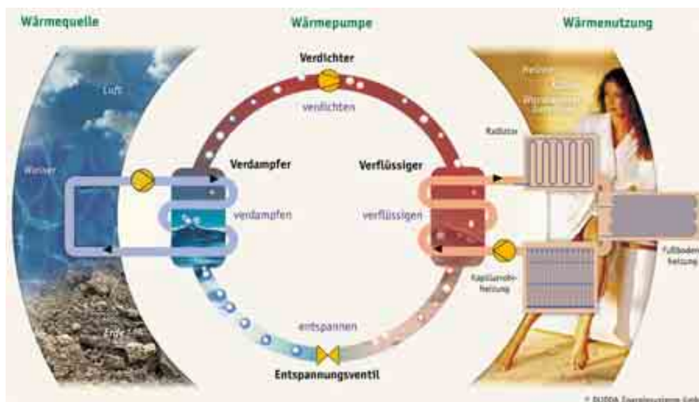
Funktionsschema einer Wärmepumpe 1
